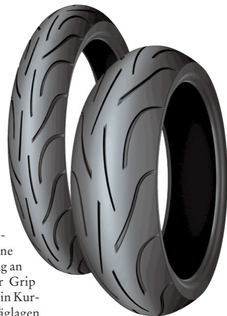
Außen weich, innen härter: Laut Michelin ist der 2CT der erste Serienreifen mit der Two-Compound-Technologie. Eine Entwicklung, die aus dem Rennsport kommt
