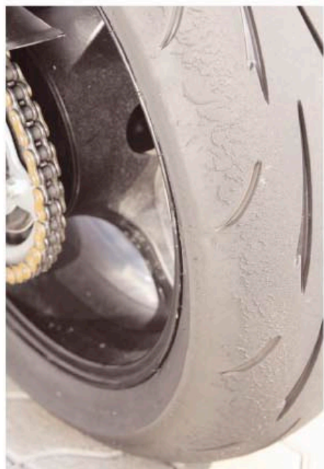
Schon nach wenigen Runden: Gummiabrieb am verschleißfreudigen Dunlop Qualifier RR
